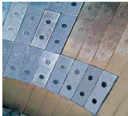
Einlauf Kohlemühle mit KALCAST
