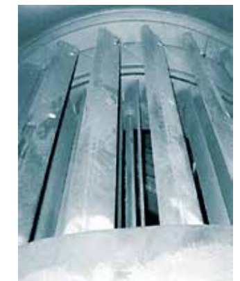
Gewichtssparende Konstruktion eines Sichterkäfigs mit Siliziumkarbidkeramik KALSICA A; Alternativen ergeben sich durch Einsatz von KALMETALL und Mosaiken aus KALOCER
