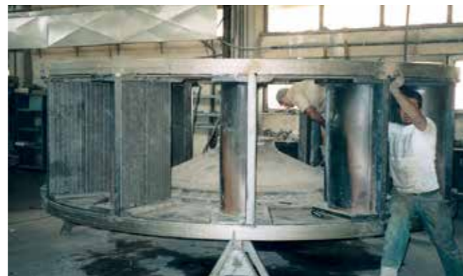
Schlagrad-Mühlen werden in Braunkohle-Kraftwerken eingesetzt; die Schlagrad-Platten sind mit KALMETALL W100 gepanzert
