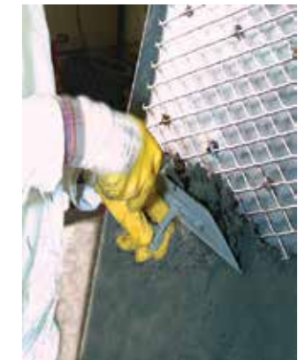
Heute werden Sichter auch vielfach mit Hartauftragschweißung KALMETALL oder fugenlos mit Hartstoffkompond KALCRET (Fotos) geschützt
