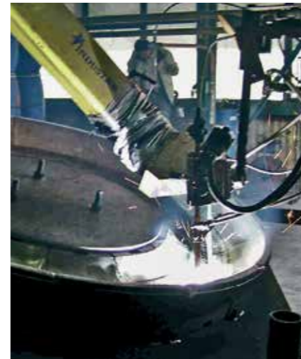
Regeneration eines Mahltellers KALMETALL W100.
