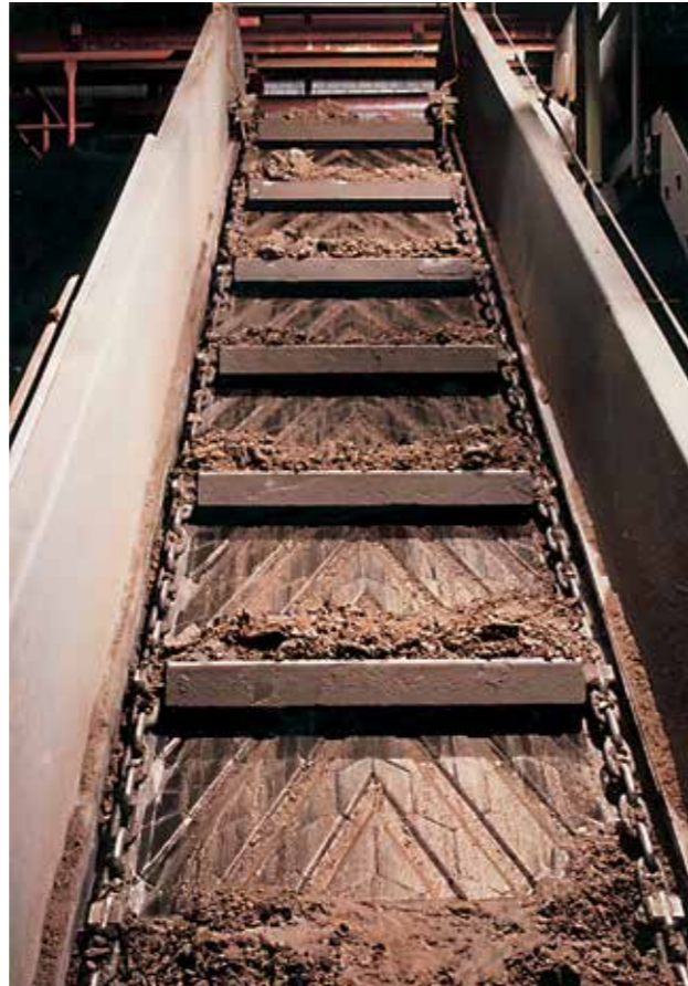
Kettenförderer für die Nassaschung werden mit Schmelzbasalt ABRESIST geschützt, auch KALCOR, KALOCER oder KALMETALL sind möglich
