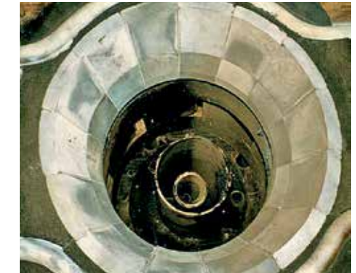
Schutz der Reflektoren von Kohlestaubbrennern mit KALSICA N oder KALMETALL
