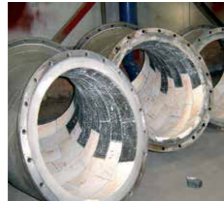
Ein Optimum an Wirtschaftlichkeit durch Werkstoff-Kombination; hier KALCOR und ABRESIST
