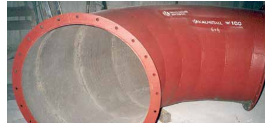
Hartauftragschweißung KALMETALL ermöglicht bei Kohlestaubbögen die Herstellung selbsttragender Konstruktionen ohne zusätzliche Auskleidung
