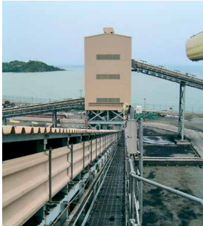
Kohleübergaben werden mit Schmelzbasalt ABRESIST oder Oxidkeramik KALOCER geschützt (Beispiel Philippinen)
