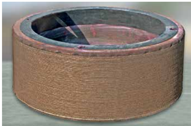
Für die Kohlemahlung liefert Kalenborn auch Mahlrollen und Mahlteller; links die Regenerierung einer verschlissenen Mahlrolle mit KALMETALL W100, rechts daneben die gegossene Mahlrolle aus KALMETALL C155 als Neuteil (jeweils 1.500 mm Durchmesser)
