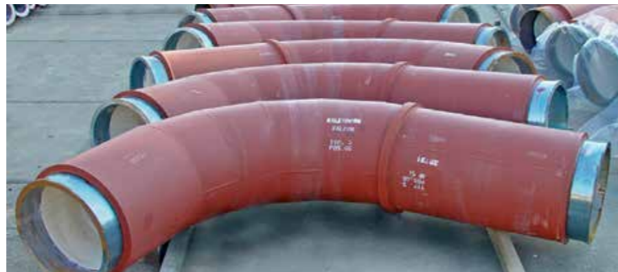
Zirkonkorund KALCOR Auskleidung und angeschweißte unausgekleidete Übergangsstücke; Durchmesser 488 mm
