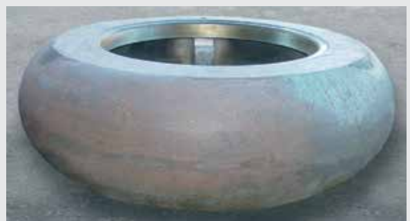
Für die Mahlsysteme Rohmaterial, Kohle und Klinker liefert Kalenborn auch Mahlrollen, Mahlteiler und Mühlen-Auskleidungen. Oben die regenerierte Mahlrolle mit KALMETALL W100, unten das neu gegossene Teil aus Hartguss KALCAST C153 (jeweils 1.500 mm Ø).
