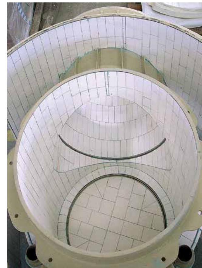
Bewährter Schutzwerkstoff für Sichter in der Zementindustrie ist Schmelzbasalt ABRESIST
