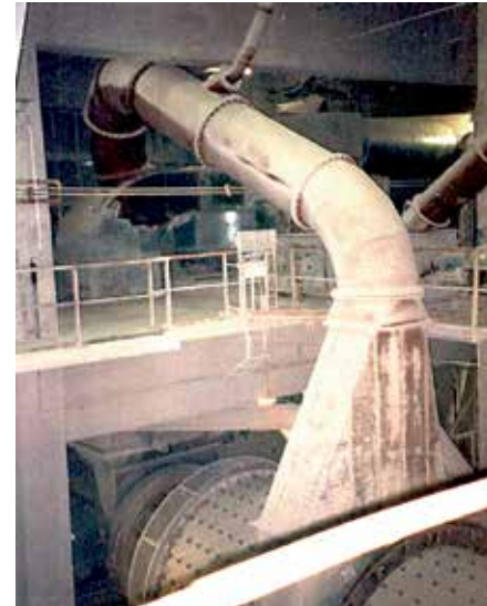
ABRESIST als Auskleidung der Mittelaustragsleitung einer Kugelmühle
