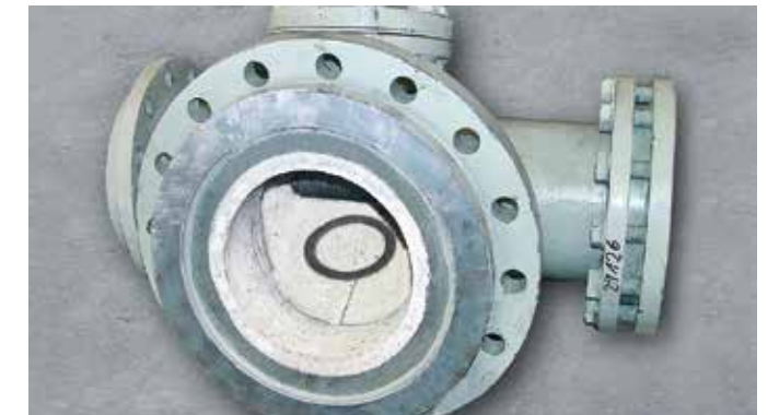
Rohrweiche in pneumatischer Förderleitung mit KALCOR Auskleidung
