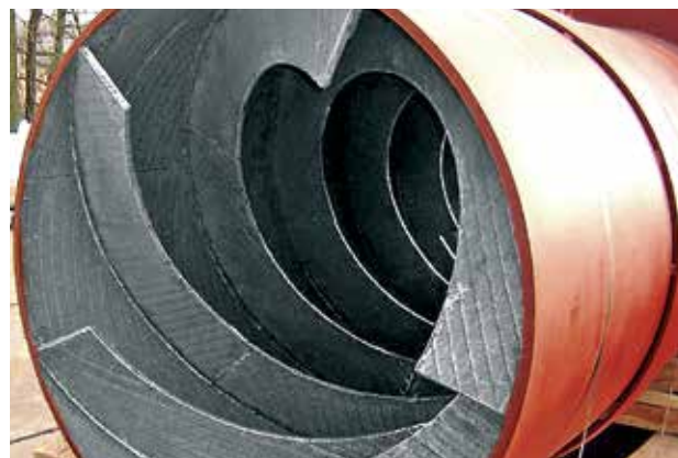
Förderschnecke für Mühleineinlaufzylinder, geschützt mit KALMETALL W100, Durchmesser 1.350 mm, Auskleidungsdicke 5 bzw. 8 mm, selbsttragende Konstruktion.
