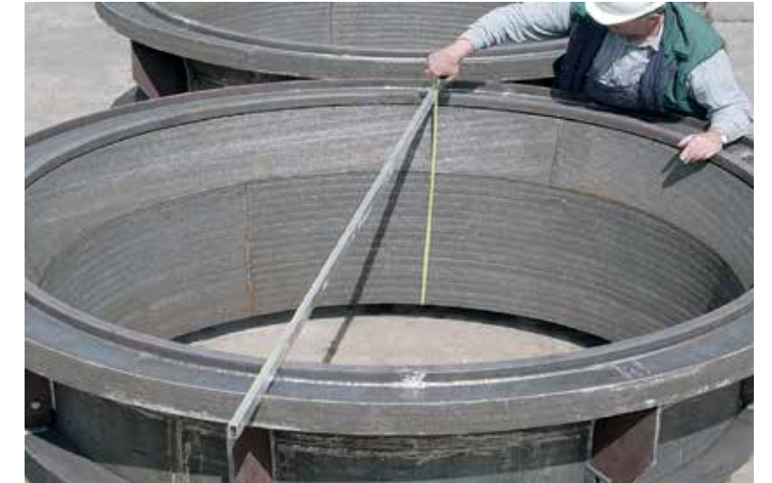
Abscheidekone von Zementsichtern aus KALMETALL W100 6 + 4, 3.000 mm Ø
