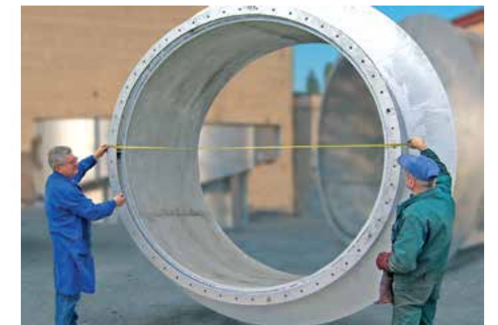
Auskleidung eines Rohrteiles in der Zementmahlung mit KALCRET BNX, bis zu 3.200 mm Ø
