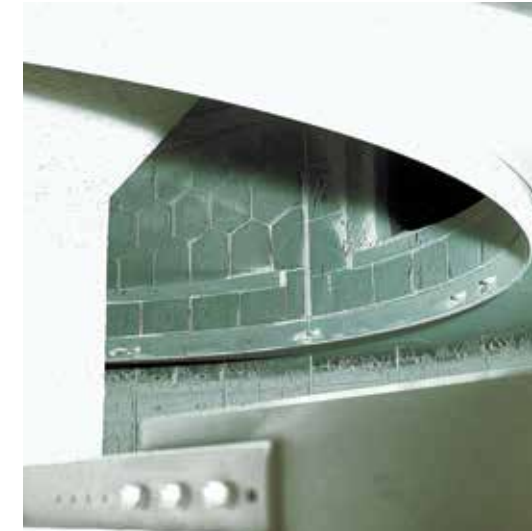
Bewährter Schutzwerkstoff für Sichter in der Zementindustrie ist Schmelzbasalt ABRESIST
