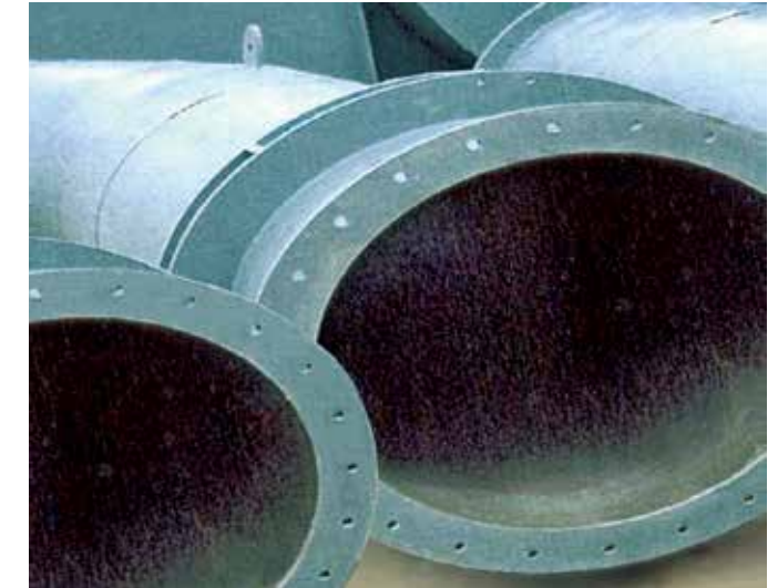
Rohmehltransport zum Vorwärmer; sicher geschützt mit KALCRET
