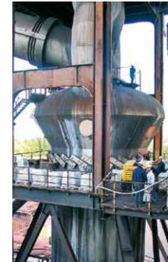
Kurze Auskleidungszeiten eines Wirblers erzielt man in der kombinierten Auskleidung von Hartstoffkompond KALCRET BTS und Zirkonkorund KALCOR. Die Aufbringleistung von KALCRET BTS reicht bis zu 5 m²/h
