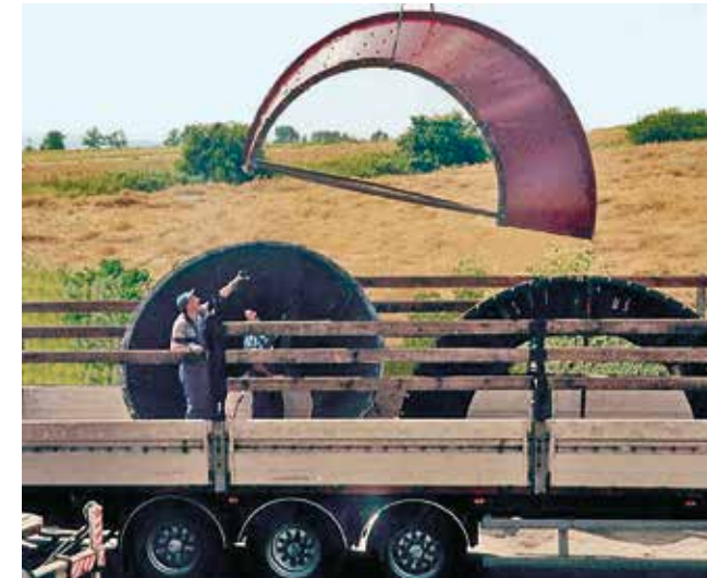
Konen für Zyklonabscheider aus KALMETALL W100 6 + 4; vorgefertigt für die einfache Montage
