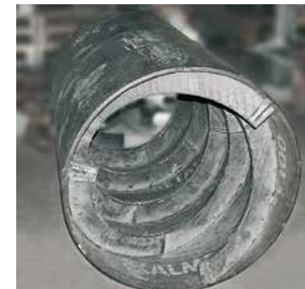
Die Schneckenflügel des Mühleneinlaufs sind beidseitig mit KALMETALL W100 gepanzert, 800 mm Durchmesser.
