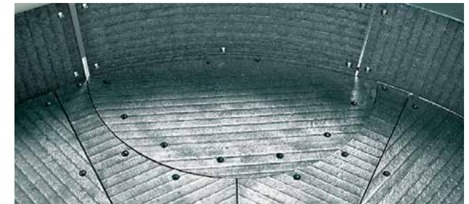
Innen-Auskleidung eines Mischers, die Seitenwände, der Boden sowie die Austragsorgane werden mit KALMETALL W100 geschützt, der Durchmesser beträgt 3.500 mm.
