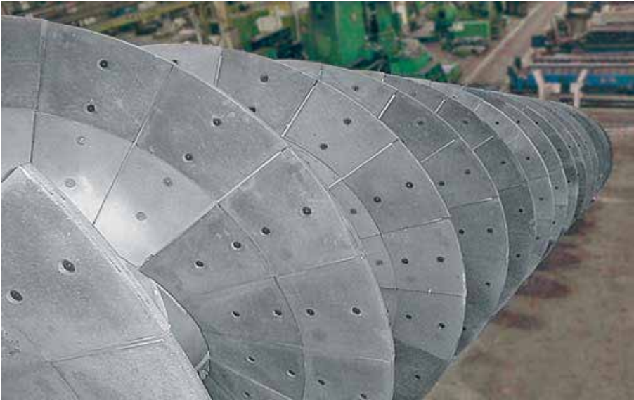
Förderschnecke geschützt mit Hartguss KALCAST. Je nach Legierung wird eine sehr hohe Abrasions- und Schlagfestigkeit erzielt.
