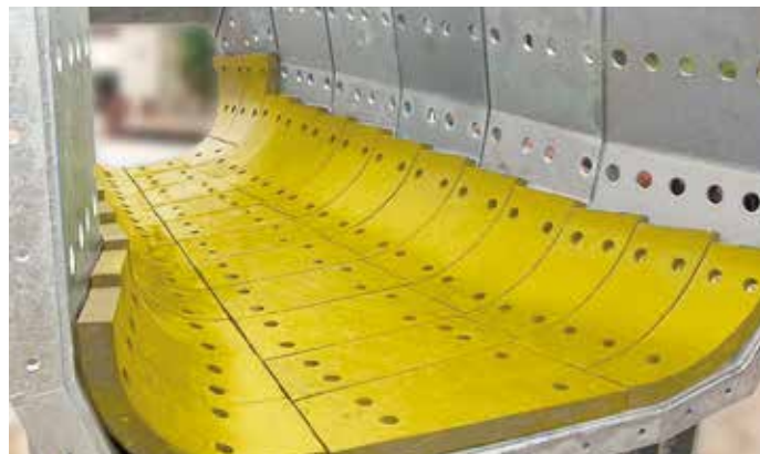
Sicherer Schutz einer Materialschurre mit 62 mm dicken Hartgussplatten KALCAST 155 und 8 mm dicker Gummiauflage für besseren Prall- und Lärmschutz.
