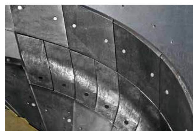
Siebe werden in verschiedensten Bereichen der Rohstoffaufbereitung eingesetzt. Das Fischgrätmuster wird in die auftragsgeschweißten Bleche KALMETALL gebrannt.
