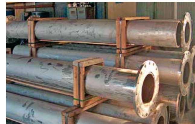
Down-Pipes einer Direktreduktionsleitung aus KALMETALL W151, Ø 355 mm; Grundmaterial 12,8 mm aus 1.4829
