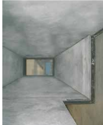
In Anlagenteilen von Schlackengranulations-Systemen hat sich Hartstoffkompond KALCRET als Auskleidungswerkstoff bewährt. Die Anlagenteile können je nach Geometrie durch Auftragen, Gießen oder Spritzen fugenlos ausgekleidet werden. Der Vorteil: Hohe Verschleiß- und Druckfestigkeit, hohe Anwendungstemperatur und kurze Montagezeiten.
