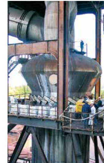
Kurze Auskleidungszeiten eines Wirblers erzielt man in der kombinierten Auskleidung von Hartstoffkompond KALCRET BTS und Zirkonkorund KALCOR. Die Aufbringleistung von KALCRET BTS reicht bis zu 5 m 2 /h
