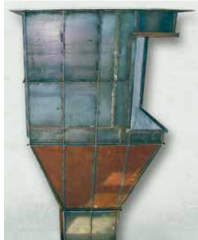
In Anlagenteilen von Schlackengranulations-Systemen hat sich Hartstoffkompond KALCRET als Auskleidungswerkstoff bewährt. Die Anlagenteile können je nach Geometrie durch Auftragen, Gießen oder Spritzen fugenlos ausgekleidet werden. Der Vorteil: Hohe Verschleiß- und Druckfestigkeit, hohe Anwendungstemperatur und kurze Montagezeiten.
