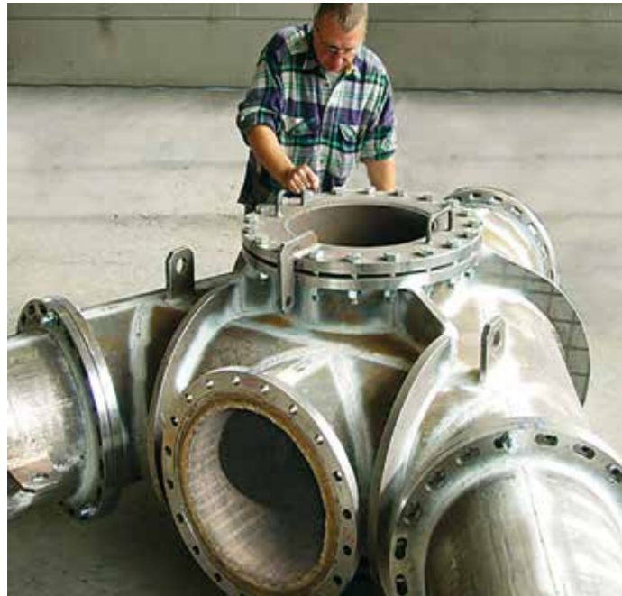
Druckausgleichsleitung am Hochofen; selbsttragende Konstruktion aus Hartauftragschweißung KALMETALL W100 30 + 6; 450 mm Ø
